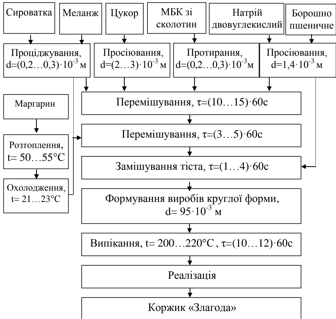
Рис. 1. Технологічна схема одержання коржика «Злагода».
