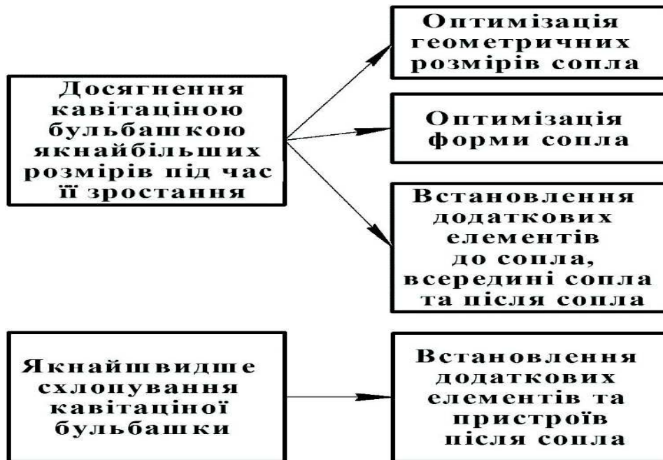
Рис. 2. Основні шляхи збільшення інтенсивності кавітації в соплі
