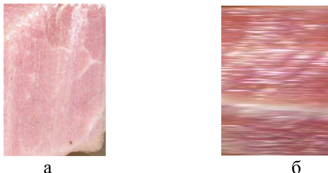
Рис. 4. Фотографии поверхностей разреза струями в замороженном свином мясе: а – водополимерной струей; б – водяной струей.
