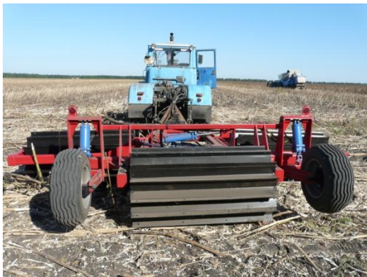
Рис. 1. Загальний вигляд (а) та схема (б) котка-подрібнювача КП 4-5: 1 – сниця; 2 – опора; 3 – рама; 4 – робочий орган; 5 – гідрофікований механізм переведення машини у транспортне положення
