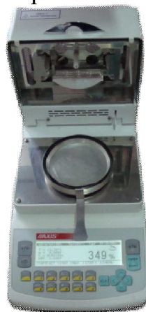
Рис. 2. Лабораторний аналізатор вологості «AXIS»
