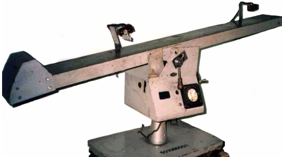
Рис. 3. Лабораторна установка для визначення коефіцієнту тертя ТМ21-А
