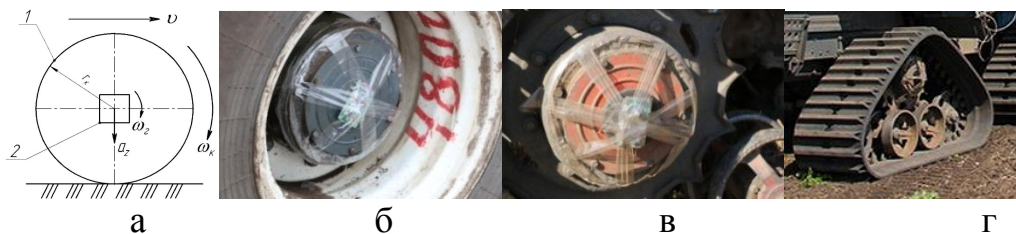
Рис. 1. Схема встановлення датчика швидкості обертання колеса (а) та датчика, встановленого на колесо трактора: ХТЗ-17224 (б), ХТЗ-200 (в), ХТЗ-280Т (г)
