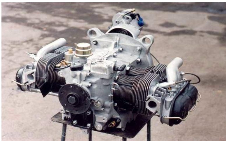
Рис. 1. Первый оппозитный двигатель автомобиля «Жук»
