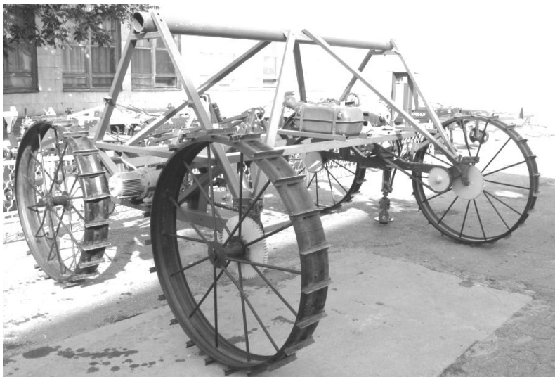
Рис. 2. Спеціалізований енерготехнологічний агросасіб для колійної системи землеробства з колією 3 м, розроблений науковцями Таврійського державного агротехнологічного університету (м. Мелітополь)
