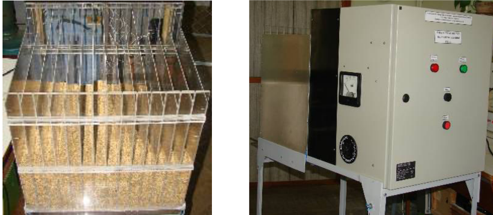
Рис. 1. Зовнішній вигляд установки для обробки зерна сільськогосподарських культур в електричному полі високої напруженості.
