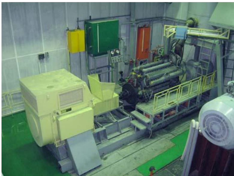
Рис.3. Стенд для обкатки двигателей ОТС 5
