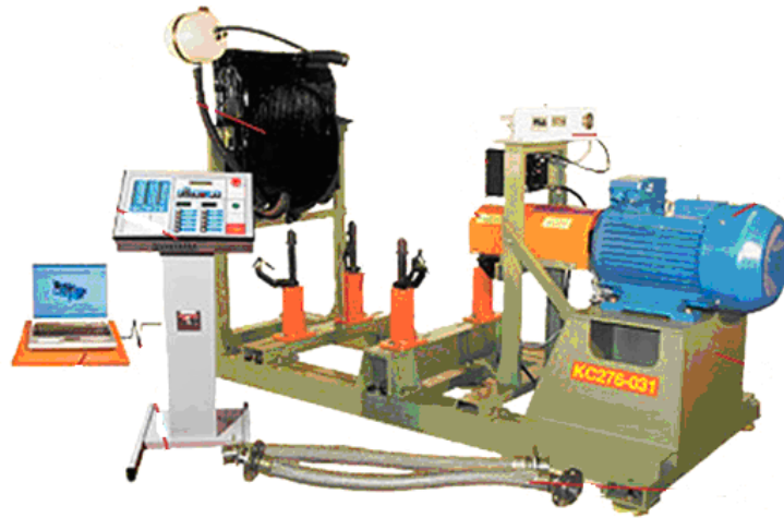
Рис.2. Стенд для обкатки двигателей КС-276-032
