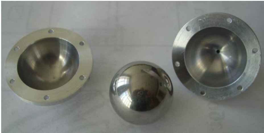
Рис. 4. Основні деталі дослідного зразка інерційного демпфера
