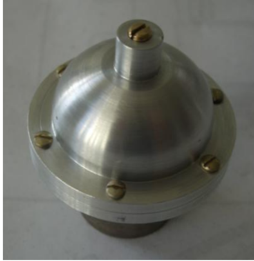
Рис. 3. Дослідний зразок розробленого інерційного демпфера
