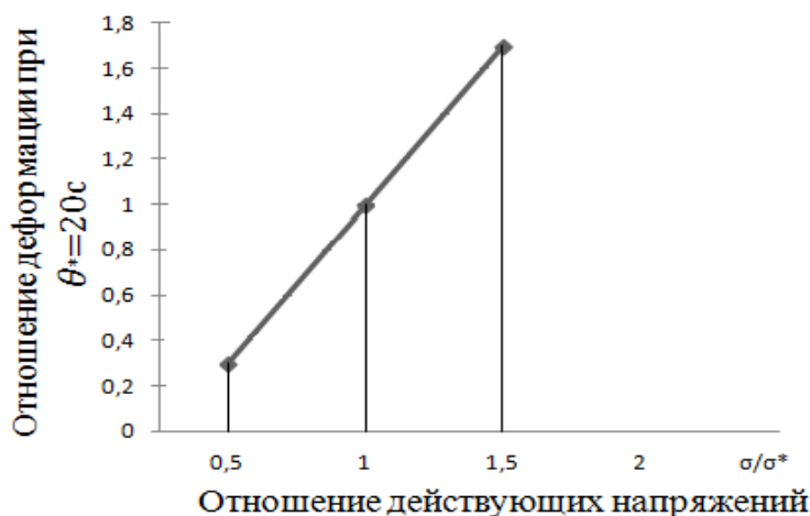
Рис. 3. Зависимость отношения деформаций от отношения действующих напряжений \sigma/\sigma_* .
