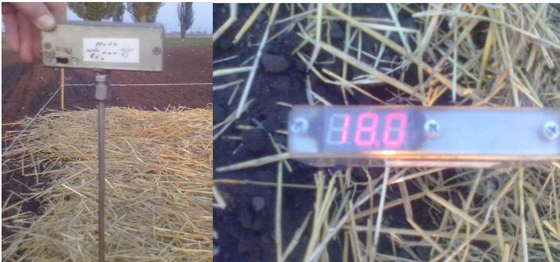
Рис.1. Прилад для дослідження теплофізичних характеристик ґрунту
