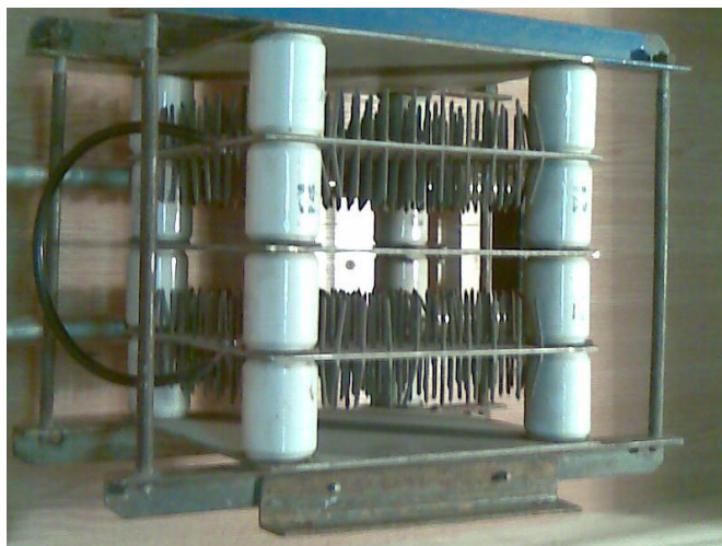
Рис.1. Проточний електроозонатор в воздуховоде сушилки.
