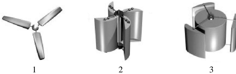
Рис. 1. Классификация ветроустановок по расположению ротора: 1 – горизонтальная ось вращения; 2 – вертикальная ось вращения; 3 – ортогональный ветродвигатель.
