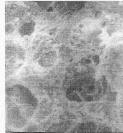
Рис. 3. Мікроструктура робочих поверхонь контакт-деталей дослідного композиційного контактного матеріалу 95\%Ag+4\text{мас}\%Zr+1\text{мас}\%Y_2O_3 при 5 \times 10^4 циклів комутацій та навантаженні 10 А постійного струму.
