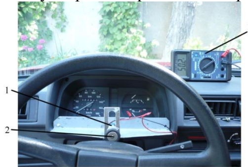
Рис. 2. Датчик поворота рулевого колеса: 1 – проволочный потенциометр Vishay Spectrol 534-1-1; 2 – колесико; 3 – цифровой мультиметр.
