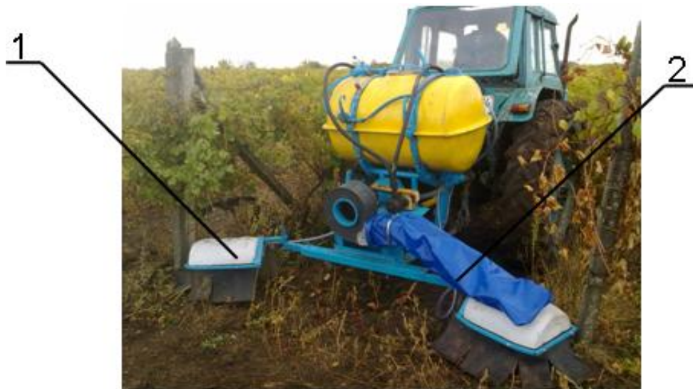
Рис.2. Лабораторно-полевая экспериментальная установка на-весного гербицидного опрыскивателя.
