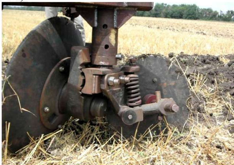
Рис. 3. Механизм крепления диска к стойке
