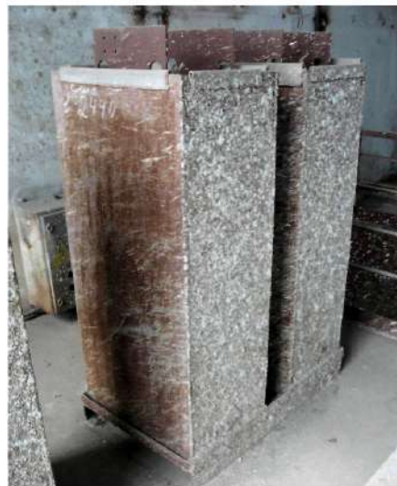
Рис. 1. Загальний вигляд електрокоагулятора.
