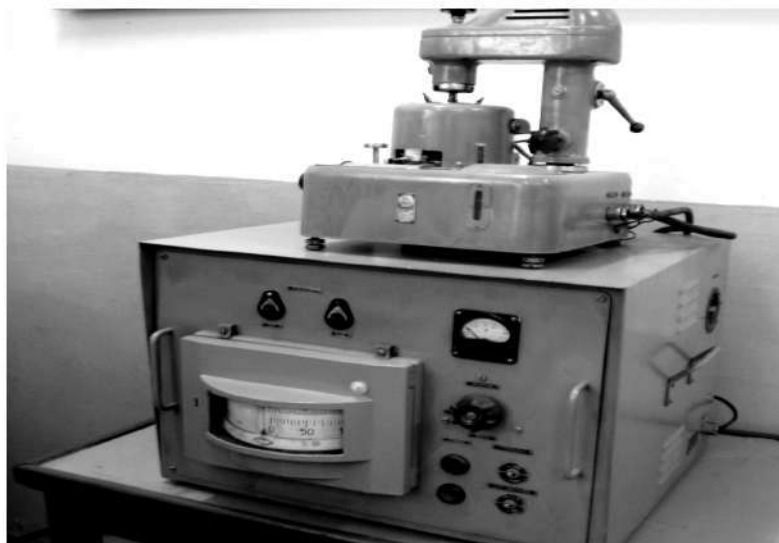
Рис. 1. Загальний вигляд машини тертя МАСТ-1 для триботехнічних випробувань олій.
