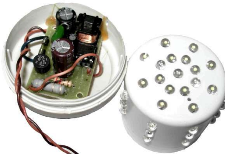
Рис. 3. Дослідний зразок світлодіодної лампи з світлодіодами розсіяного світла.
