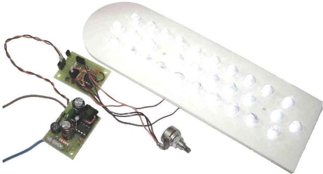
Рис. 2. Дослідний зразок світлодіодного світильника.
