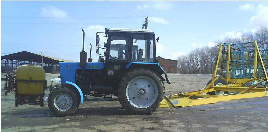
Рис. 3. Комбінований МТА на базі трактора МТЗ-82.1 з фронтально розташованим оприскувачем «Ренау» та бороною БЗП.
