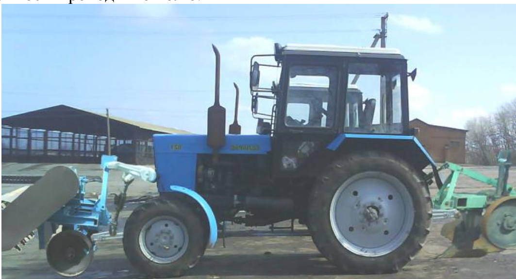
Рис.3. Комбінований МТА на базі трактора МТЗ-82.1 з фронтальнорозташованим подрібнювачем ПРР-1,5 та плугом ПЛН-3-35.
