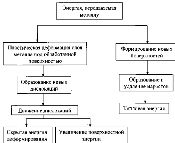
Рис.3. Схема дислокационно-энергетической модели распределения энергии, передаваемой металлу в процессе обработки металлической щеткой
