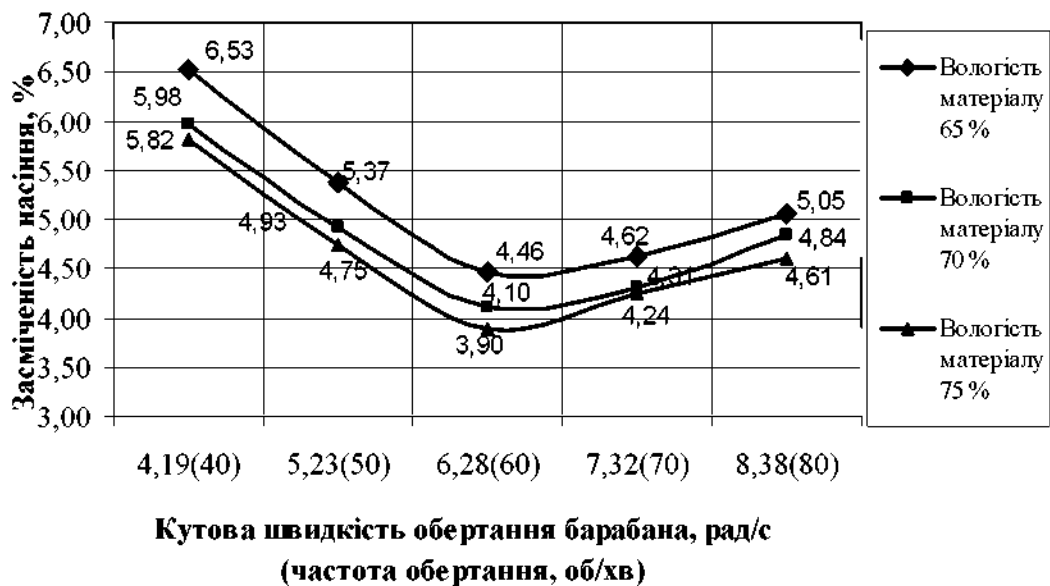
Рис. 3. Залежність засміченості насіння від швидкості обертання барабана та вологості частинок насінників
