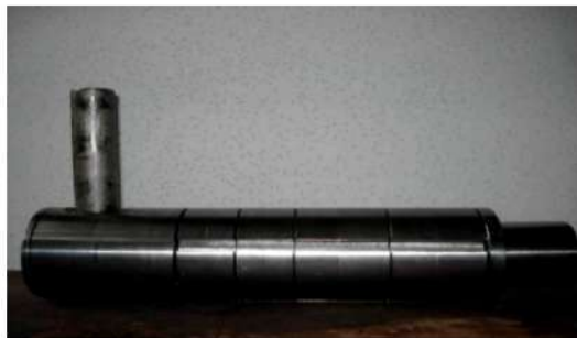
Рис. 2. Общий вид прямоструйного воздушного эжектора
