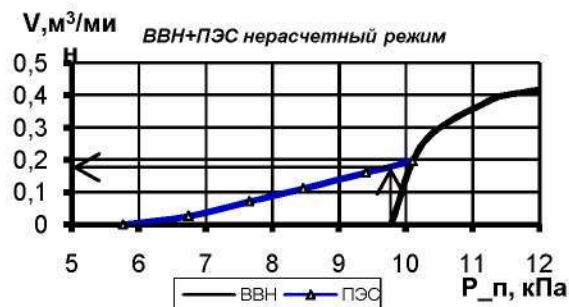
Рис. 4. Характеристика вакуумного агрегата с ПЭС на нерасчетном режиме работы ВВН-1,5 с температурой воды на линии всасывания T_w=25^\circ\text{C}
