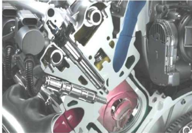
Рис. 2. Розміщення форсунки та свічки запалювання
