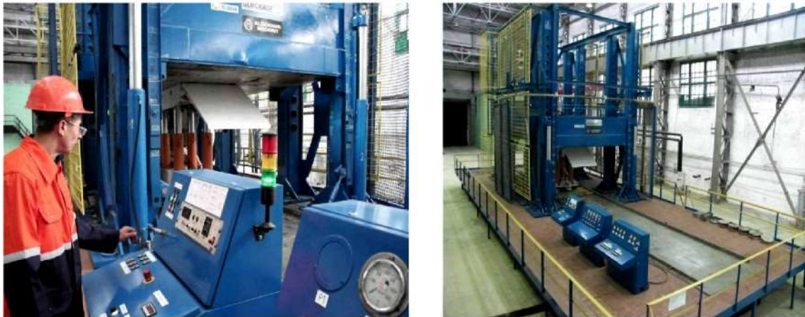
Рис. 1. Испытания секции крепи на испытательном стенде «Gluckauf»
