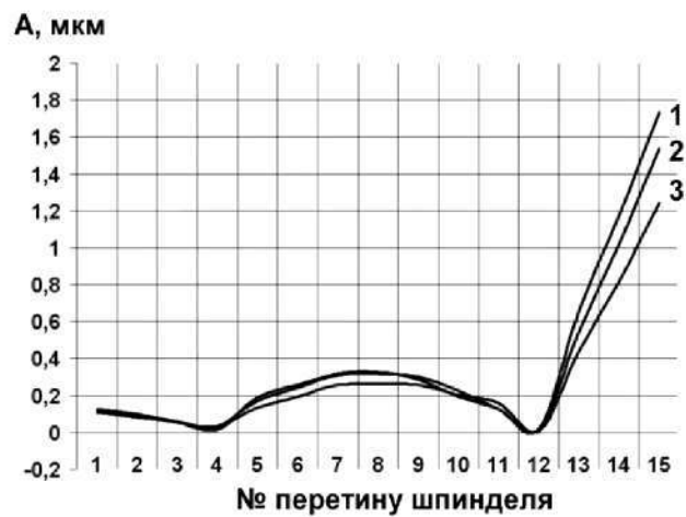
Рис. 5. Розподіл амплітуд коливань по довжині шпинделя (1 - \Delta=80 мкм; 2 - \Delta=60 мкм; 3 - \Delta=40 мкм)
