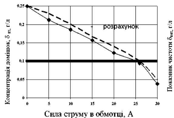
Рис. 3. Залежність показника чистоти МОР при зміні струму в обмотці при \delta_{\text{вх}} = 0,25 г/л.
