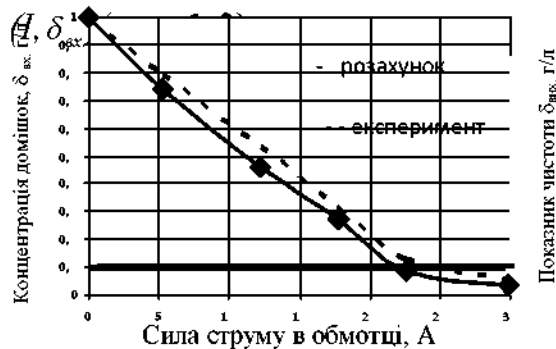
Рис. 1. Залежність показника чистоти МОР при зміні струму в обмотці при \delta_{\text{вх}} = 1 г/л.
