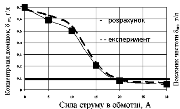
Рис. 2. Залежність показника чистоти МОР при зміні струму в обмотці при \delta_{\text{вх}} = 0,7 г/л.
