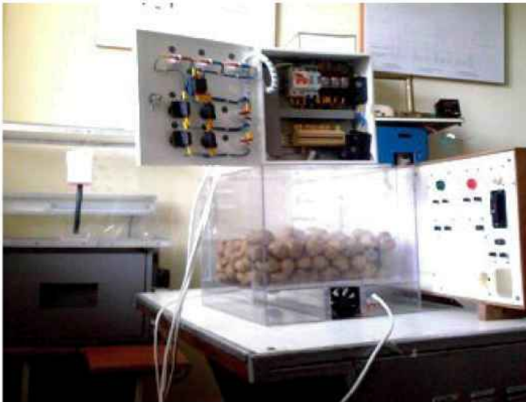
Рис. 1. Експериментальна установка для перевірки роботи САУ.
