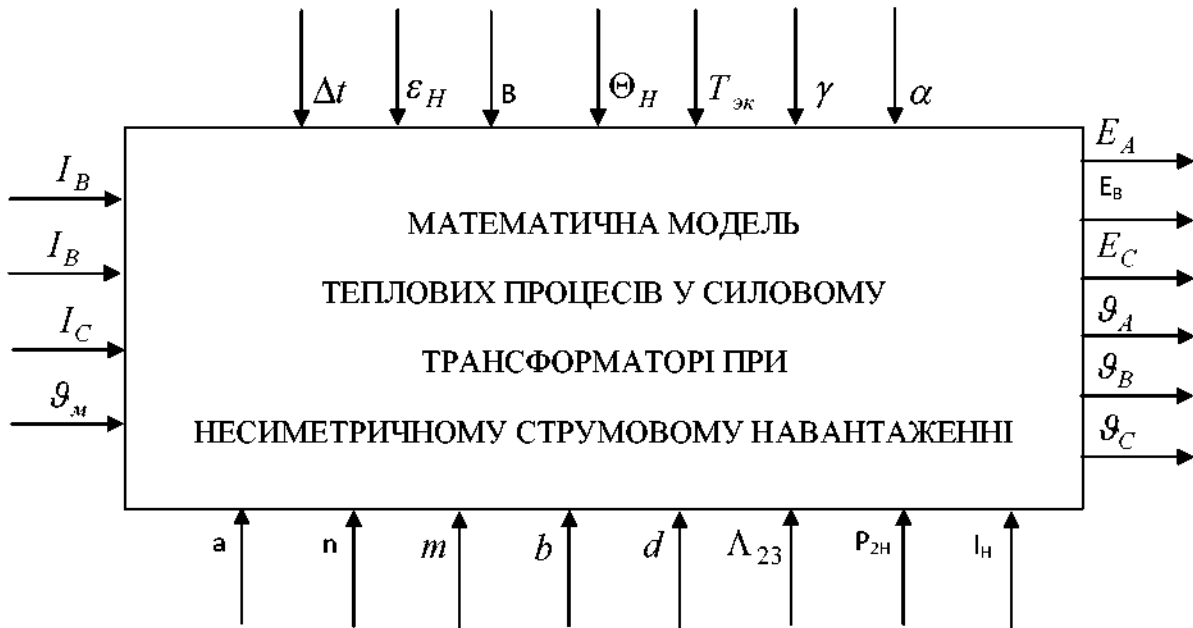
Рис. 1. Структурная схема математичної моделі теплових процесів у силовому трансформаторі під дією експлуатаційних факторів.
