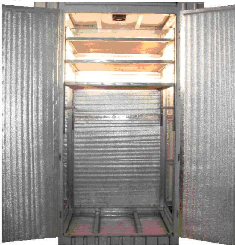
Рис.4. ИК сушильная камера (двери камеры открыты).
