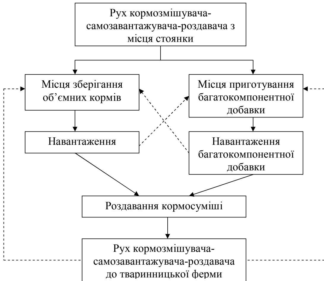
Рис.1. Принципова схема доставки та роздавання кормів кормозмішувачем-роздавачем, що обладнаний системою самозавантаження та зважування.
