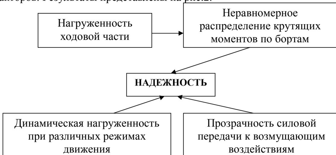
Рис.2. Факторы, влияющие на надежность силовых агрегатов гусеничных тракторов
