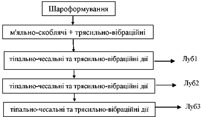
Рис. 1. Схема технологічного процесу виділення лубу конопель
