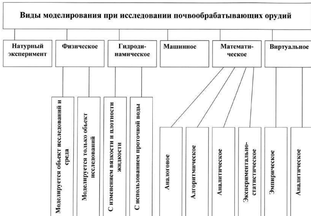
Рисунок 1 – Виды моделирования при исследовании почвообрабатывающих орудий.
