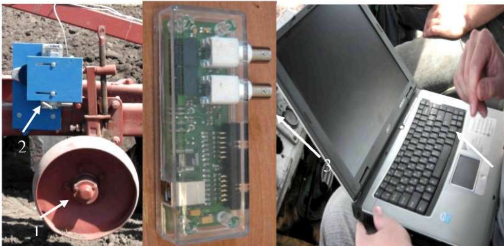
Рисунок 5 – Вимірювально – реєструючий комплекс для досліджень рівномірності обробки ґрунту:
