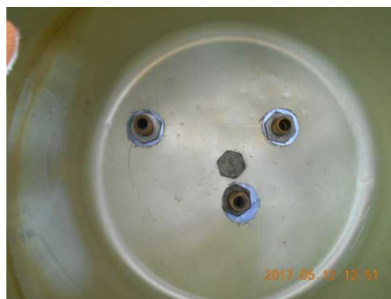
Рис. 5. Штуцери для приєднання відвідних шлангів
