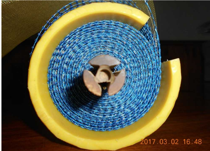
Рис. 1. Укладка сіток на стрижні
