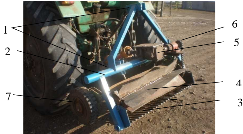
Рис. 5. Експериментальна установка: 1 – навісний пристрій; 2 – рама; 3 – викопуючі робочі органи (набір доліт); 4 – бітер; 5 – редуктор; 6 – привід; 7 – опорне колесо
