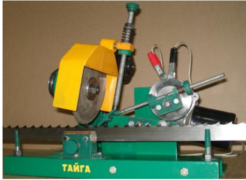
Рис.1. Зовнішній вигляд двокулачкового заточувального верстату 3К-327 «Тайга»
