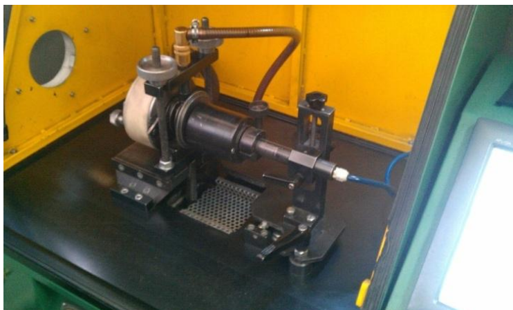
Рис. 8. Стенд для проведения испытаний турбокомпрессора
