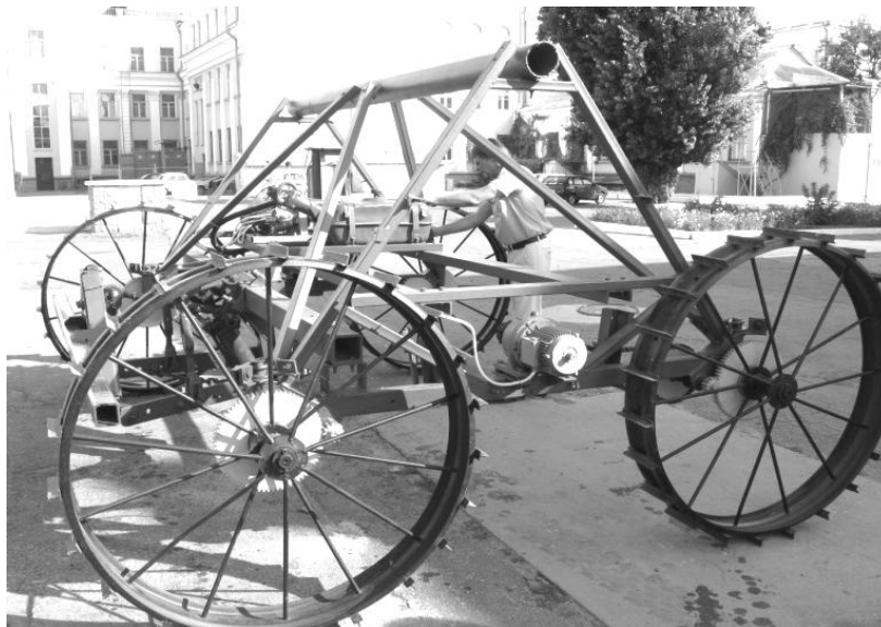
Рис. 2. Спеціалізований енерготехнологічний агрозасіб для колійної системи землеробства, розроблений науковцями Таврійського державного агротехнологічного університету (ТДАТУ, м. Мелітополь).
