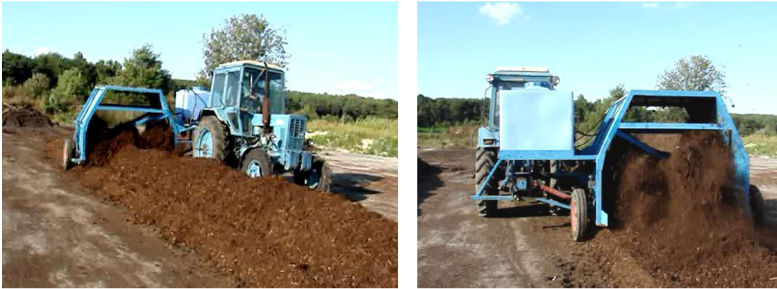
Рис. 2. Змішувач-аератор компостів у роботі.
