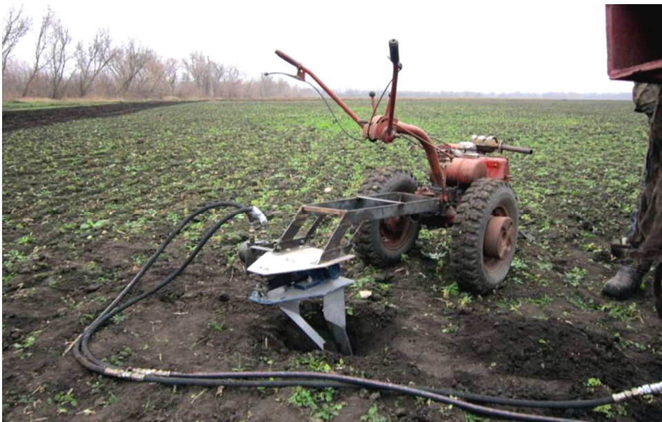
Рис. 4. Робочий момент експериментальних досліджень на підкопуванні часника – визначення дросель-витратоміром потужності на привід ексцентрикового механізму.
