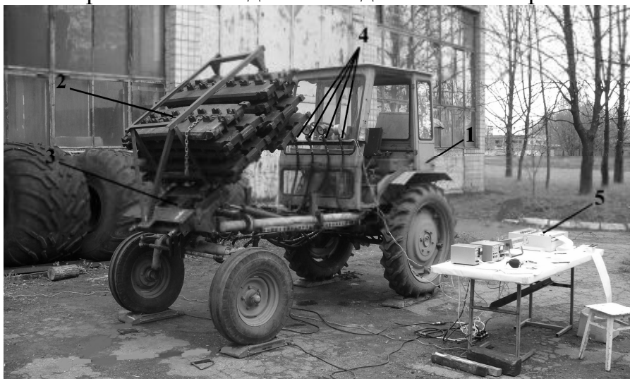
Рис. 1. Самохідне шасі Т-16МГ під час проведення досліджень: 1 – самохідне шасі Т-16МГ; 2 – імітатор ТМ; 3 – пристрій для агрегування; 4 – датчики вимірювання тиску ПМ-100; 5 – пристрій швидкодіючий самопишучий Н338-6П.
