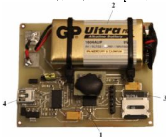
Рис. 2. Розроблений автономний акселерометр: 1 – акселерометр; 2 – батареяка типу крона; 3 – карта пам'яті; 4 – адаптивний мікропорт для зчитування даних.
