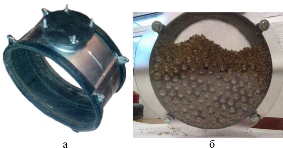
Рис. 3. Дослідження процесу вібровідцентровго подрібнення: а – дробильна камера; б – розміщення дробильних елментів та оброблювального матеріалу в дробильній камері.
