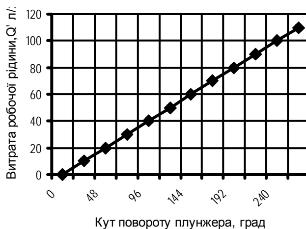
Рис. 6. Тарувальна характеристика витратоміра постійного перепаду тиску.
