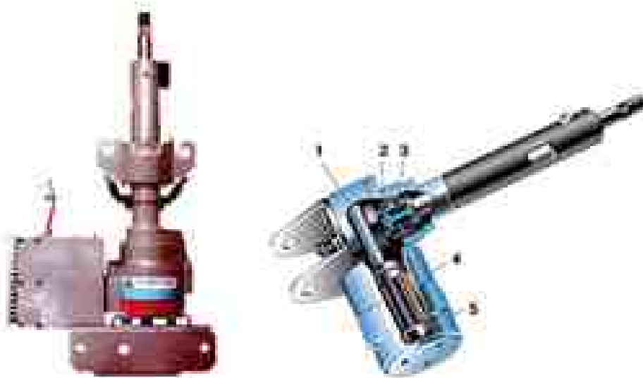
Рис. 1. Внешний вид и основные части усилителя: 1 - многозаходный червячный редуктор; 2 - индукционный датчик передаваемого момента; 3 - торсион; 4 - ротор электродвигателя; 5 - датчик положения ротора (диск с прорезами).
