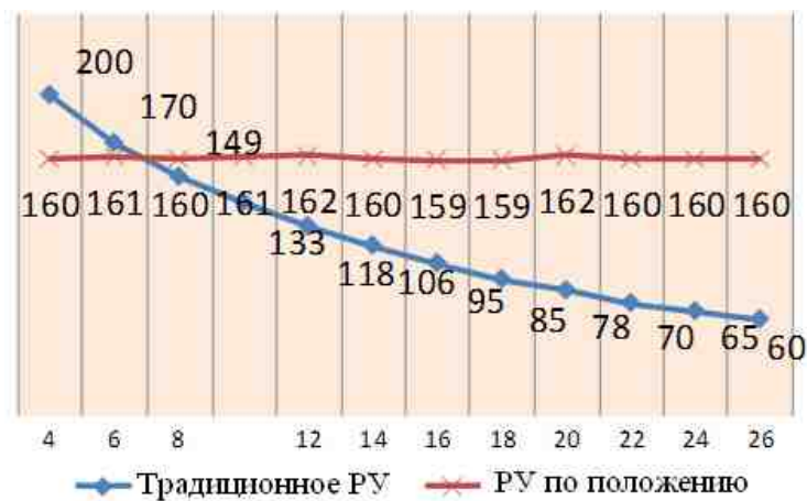
Рис. 5. Зависимость добротности от скорости движения транспортного средства (км/ч).
